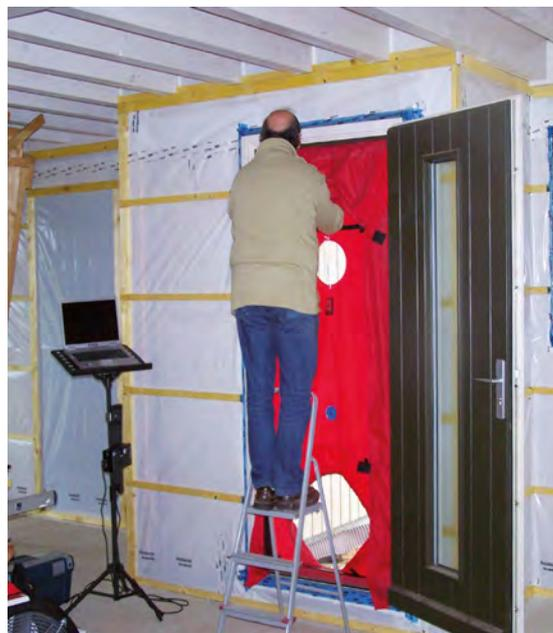
C'est pourquoi la performance doit être au moins équivalente à une fermeture de qualité à savoir une performance d'étanchéité ou débit de fuite **< 0.6m<sup>3</sup>/(h.m<sup>2</sup>)\***.
